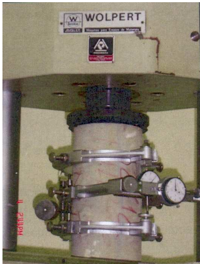
FIGURA 4.8 – Ensaio de módulo de elasticidade
