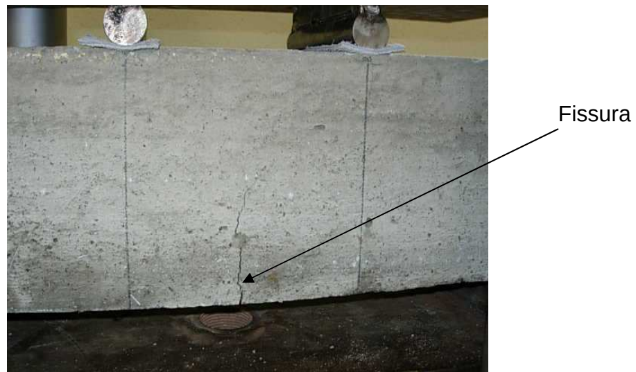
FIGURA 4.7 – Corpo-de-prova prismático solicitado à tração na flexão.
