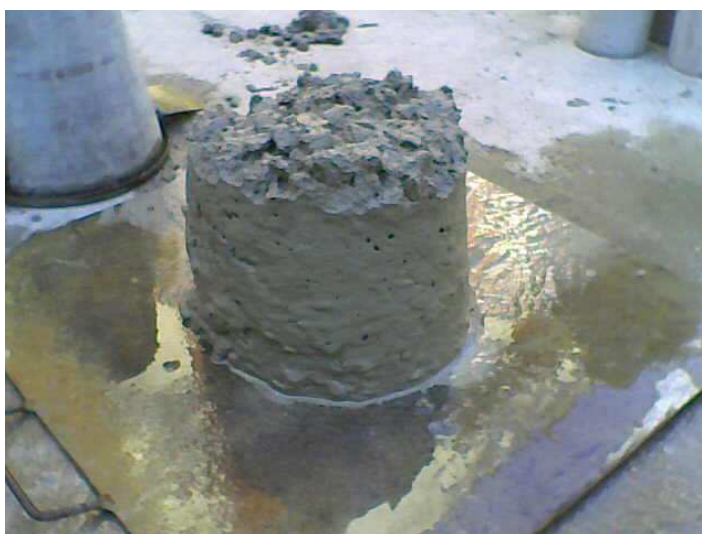
Figura 5.1 – Abatimento da mistura com 100% de RMT e CP II E 32 (S = 140 mm).
