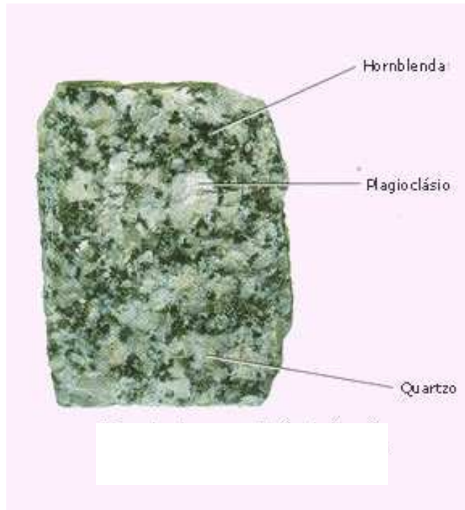
Figura 2.2 – Exemplar de granito destacando três de seus minerais ( http://www.igc.usp.br/geologia/o_uso_dos_minerais.php ).
